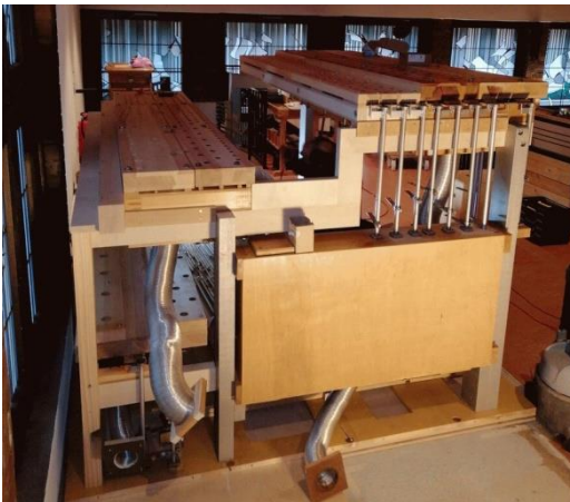
Das Hauptwerksgerüst mit den Windladen, worauf die Pfeifen stehen.
